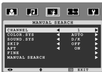
**CHANNEL** – Номер телеканала. Здесь отображается номер текущего телеканала. Чтобы переключиться на другой канал, нажмите кнопку  $\triangleleft/\triangleright$ .
