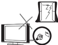
Для дополнительной защиты данного телевизора при грозовой погоде или когда не планируется его использование в течение длительного времени, отключите телевизор от розетки питания и отсоедините от него штекер антенного кабеля. Это предотвратит повреждение телевизора от молний или из-за перепадов напряжения.
