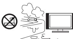
Не используйте телевизор вблизи воды, например, рядом с раковиной, мойкой или стиральной машиной, во влажном подвале, вблизи бассейна и т. д. После транспортировки в условиях низкой температуры перед включением телевизора дайте выдержку около часа при комнатной температуре, не включайте телевизор сразу, так как это приведет к образованию конденсата, что может вызвать пожар, поражение электрическим током или другие последствия.
