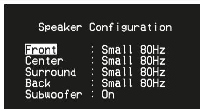
Любая система объемного звука нуждается в "управлении низкими частотами" для направления низкочастотных сигналов нескольких или всех каналов на акустические системы, способные наилучшим образом воспроизвести их. Для корректной работы этой функции важно точно определить возможности акустических систем. Мы используем термины Small ("Малая") и Large ("Большая") (а также опция Off – "отсутствующая"), но имейте в виду, что физический размер может не соответствовать техническим возможностям.
