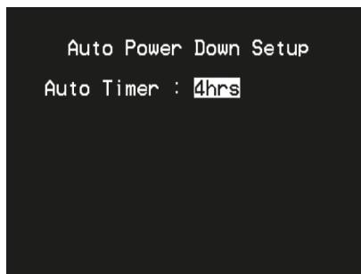
Т 748 можно настроить для автоматического перехода в режим ожидания при отсутствии действий пользователя в течение заданного времени. Установите для параметра Auto Timer (Автоматический таймер) предпочтительное время.
