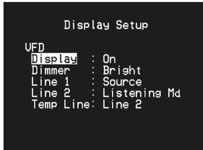
С помощью меню Display Setup изменяется вид дисплея ресивера и экранного меню. Навигации по меню осуществляется с помощью кнопок **►** или **ENTER** и **▲/▼**.
