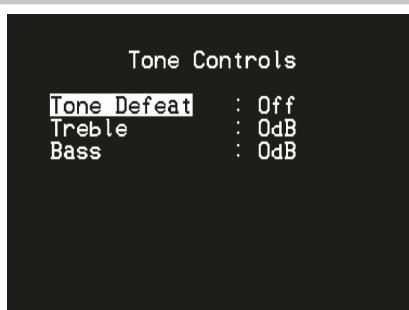
Ресивер T 748 имеет два регулятора тембра – Treble (Высокие частоты) и Bass (Низкие частоты). Регуляторы Bass и Treble затрагивают только низкие частоты нижнего диапазона и высокие частоты верхнего диапазона, оставляя важные средние частоты без изменения.
