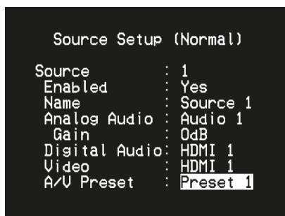
В примере выше набор установок Preset 1 назначен для источника Source 1. При подключении источника Source 1 автоматически применяются настройки набора установок Preset 1. Вы можете изменить назначение набора установок для источника вручную с помощью соответствующих кнопок пульта дистанционного управления.
