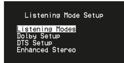
Ресивер T 748 предусматривает различные варианты режимов прослушивания, большинство из которых конфигурируемые. Режимы предназначены для обработки звука различными эффектами в зависимости от воспроизводимого источника. Конфигурирование выполняется с помощью кнопок ► или ENTER и ▲▼.
