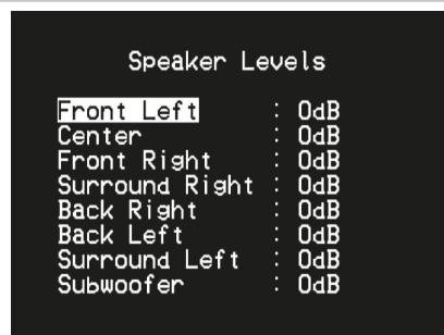
Регулировка баланса акустических систем, подключенных к вашему ресиверу, обеспечивает при воспроизведении любой записи, будь то музыка или фильм, такую звуковую картину, сбалансированность эффектов, музыки и диалогов, которая была задумана изначально. Кроме того, если к ресиверу подключен сабвуфер, регулировка баланса позволяет добиться правильно соотношения уровня громкости сабвуфера и других акустических систем, и, соответственно, низких частот с другими звуковыми элементами.
