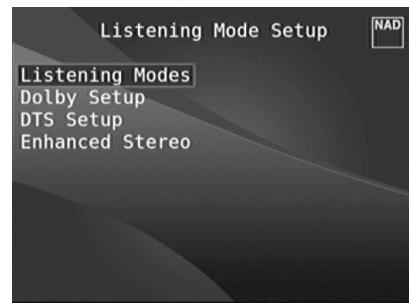
Ресивер Т 757 предусматривает различные варианты прослушивания, большинство из которых конфигурируемые. Режимы предназначены для обработки звука различными эффектами в зависимости от воспроизводимого источника. Конфигурирование выполняется с помощью кнопок [**◀/▶**] или ENTER и [**▲/▼**].
