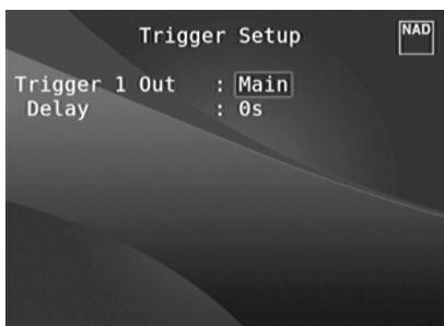
В Т 757 имеется настраиваемый вывод +12 В постоянного тока, который можно использовать для активации компонента или системы, к которой он подключен. Триггеры представляют собой низковольтные сигналы, используемые для включения-выключения совместимых устройств.
