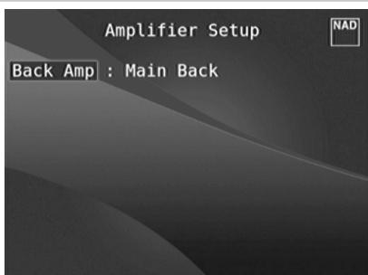
Если тыловые акустические системы окружающего звука не используются в основной зоне, то каналы их усилителя могут быть назначены для тылового канала основной зоны (Main Back), фронтального канала основной зоны (Bi-Amp) и Зона 2 (Zone 2) использования.
