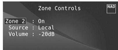
В зависимости от настроек, выполненных в меню "Настройка зон" в разделе "Меню настройки", можно сконфигурировать и осуществлять управление зоной 2 с помощью окна Zone Controls ("Управление зонами").
