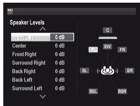
Регулировка баланса акустических систем, подключенных к вашему ресиверу, обеспечивает при воспроизведении любой записи, будь то музыка или фильм, такую звуковую картину, сбалансированность эффектов, музыки и диалогов, которая была задумана изначально. Кроме того, если к ресиверу подключен сабвуфер, регулировка баланса позволяет добиться правильного соотношения уровня громкости сабвуфера и других акустических систем, и, соответственно, низких частот с другими звуковыми элементами.
