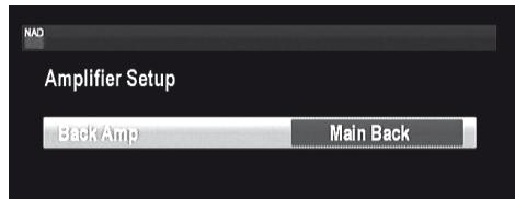
Если тыловые акустические системы окружающего звука не используются в основной зоне, то каналы их усилителя могут быть назначены для тылового канала основной зоны (Main Back), фронтального канала основной зоны (Bi-Amp) и Зона 2 (Zone 2) использования.
