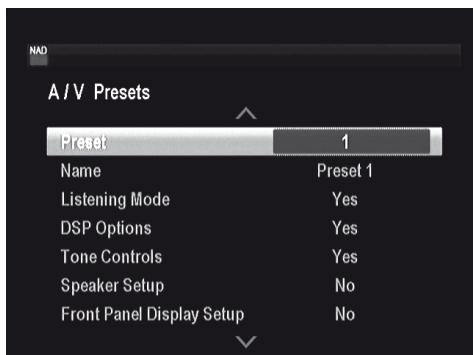
Простая, но мощная и гибкая система пресетов ресивера T 747 позволяет Вам настраивать по своему вкусу практически каждый параметр, используемый при воспроизведении аудио-видео. Все эксплуатационные параметры ресивера T 747, "Listening Mode", "DSP Options", "Tone Controls", "Speaker Setup" и "Front Panel Display Setup", сохраняются в памяти аппарата в совокупности как один пресет.
