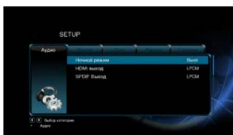
Это меню предназначено для настройки параметров звука, включая Ночной режим/ HDMI выход/ SPDIF выход.
