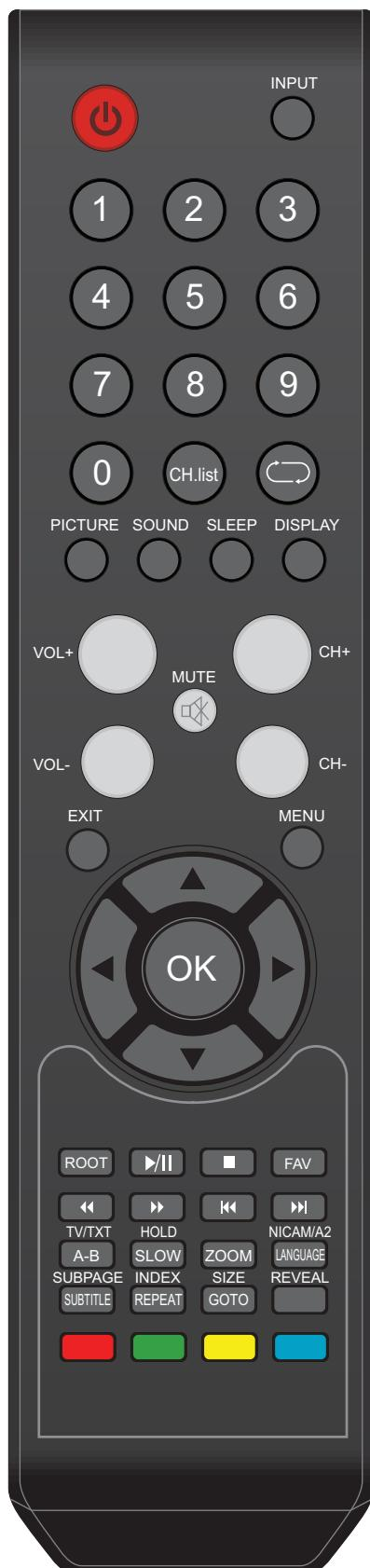
**POWER** Кнопка включения телевизора / перехода в режим ожидания.
