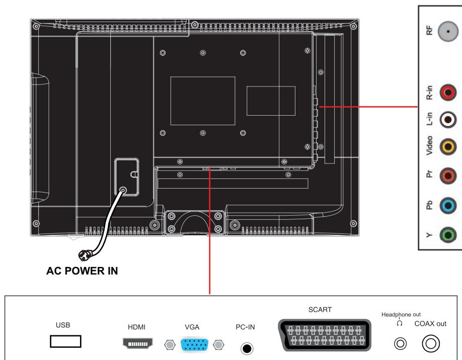
**AC POWER IN** – Разъем для подключения кабеля от адаптера питания
