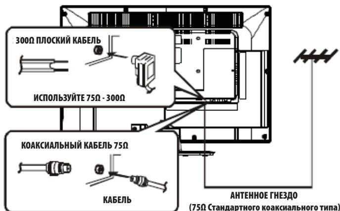
Сопротивление антенного входа телевизора – 75 Ом. МВ/ДМВ коаксиальный кабель может быть подключен напрямую к антенному гнезду, в то время как при использовании плоского кабеля 300 Ом для подключения к телевизору вам потребуется конвертер 300 Ом / 75 Ом.
