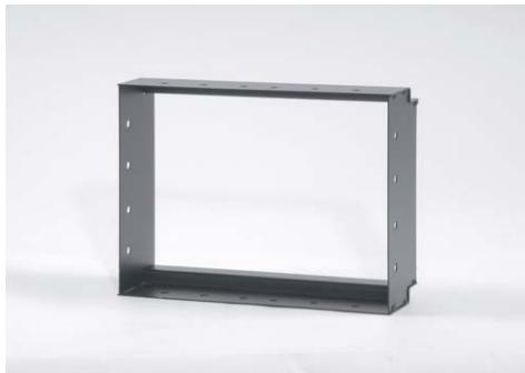
Für die Installation der InWall Systeme bei Häusern in Massivbauweise empfiehlt sich der Einsatz eines speziellen Einbaurahmens. Bei Neubauten bestimmt dieser Rahmen schon im Mauerwerk die zukünftige Position der Lautsprecher. Bei nachträglich vorgenommenen Einbauten schließt dieser Rahmen die Öffnung in der Mauer sauber ab. Der Einbaurahmen ist über den Canton Kundendienst zu beziehen.
