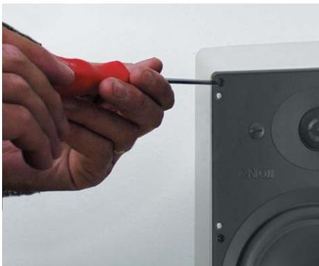
Nachdem dieser Kontakt hergestellt ist, kann das Lautsprecher System mit den sechs **schwarzen Schrauben** in dem Einbaurahmen befestigt werden. Danach können Sie das Gitter in das InWall System einsetzen.
