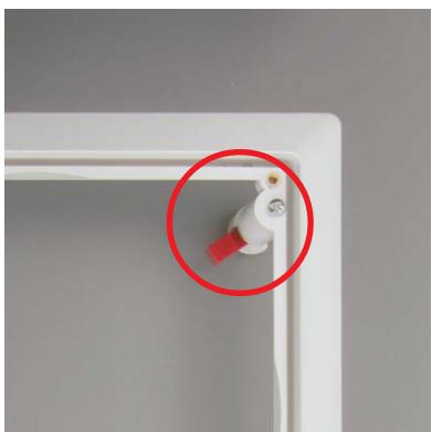
Achten Sie bitte darauf, dass die roten Befestigungslaschen (6 Stück pro Lautsprechersystem) nach innen anliegen, damit das InWall System in die Einbauöffnung passt. Setzen Sie nun den Rahmen in die Einbauöffnung und fixieren Sie ihn jeweils an den **silbernen Schrauben** in der Wand.
