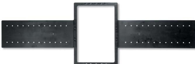
Wenn Sie beim Bau Ihres Fertighauses oder dem Dachausbau bereits die Platzierung der InWall Systeme festgelegt haben, können Sie mit der Schablone für den Trockenausbau den Abschnitt für die Installation der InWall-Lautsprecher markieren. Die Kunststoff-Schablone wird mit Nägeln am gewünschten Einbauort fixiert. Danach wird die Wand oder Decke um diese Einbauöffnung herum verkleidet.
