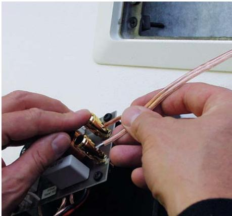
Bevor Sie die Lautsprecher-Kabel an den Klemmanschlüssen des InWall-Systems befestigen, müssen Sie die Kabel spreizen und etwa 1,5 cm der Kabelenden abisolieren. Verbinden Sie nun das markierte Kabel (+) mit dem roten Klemmanschluss an der Frequenzweiche, das zweite Kabel (-) mit dem schwarzen Anschluss.
