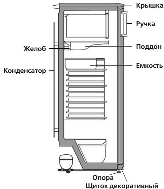
Рисунок 7 — Схема слива талой воды
