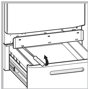
3. снимите нижний плинтус стиральной машины при помощи отвертки (см. рисунок).
