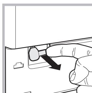
4. потяните наружу язычок, показанный на рисунке, вплоть до освобождения пластикового блокировочного винта. Затем потяните его вниз, пока не услышите щелчок, что означает разблокировку люка.
