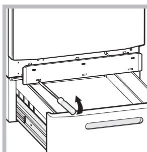
1. снимите нижний плинтус стиральной машины при помощи отвертки (см. рисунок);
