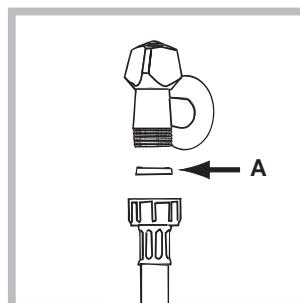
1. Вставьте прокладку А в конец водопроводного шланга и привинтите его к водопроводному крану холодной воды с резьбовым отверстием 3/4 газ (см. схему). Перед подсоединением откройте водопроводный кран до тех пор, пока из него не потечет чистая вода.
