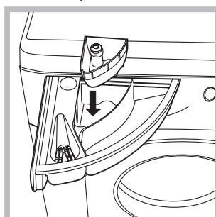
Не заливайте отбеливатель в дозатор выше отметки «макс.» на центральной шкале (см. рисунок). Для осуществления только отбеливания поместите отбеливатель в дополнительный дозатор 4 и задайте программу «Полоскание» и
