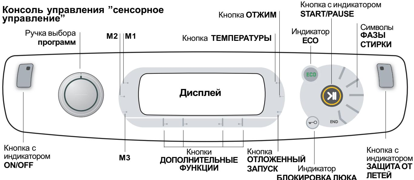
**Кнопка с индикатором ON/OFF:** нажмите кнопку один раз для включения или выключения машины. Зеленый индикатор показывает, что машина включена. Для выключения стиральной машины в процессе стирки необходимо держать нажатой кнопку, примерно 3 секунды. Короткое или случайное нажатие не приведет к отключению машины. В случае выключения машины в процессе стирки текущий цикл отменяется.
