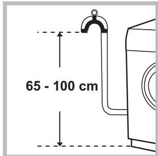
Підключіть зливний шланг до каналізації або до зливного отвору у стіні на висоті від 65 до 100 см від підлоги, не допускаючи його згинання.
