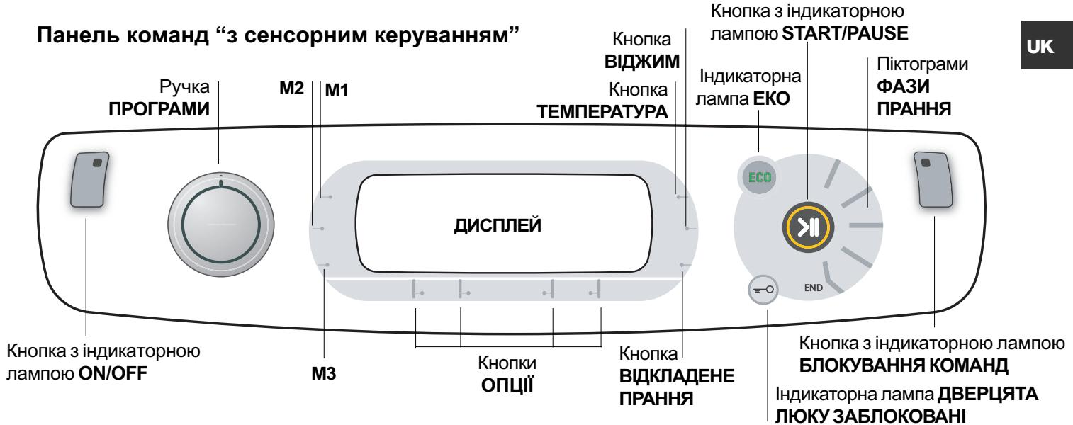
**Кнопка з індикаторною лампою ⏹ ON/OFF:** швидко натисніть і відпустіть кнопку для вимикання або вимикання машини. Зелена індикаторна лампа означає, що машина ввімкнена. Для вимикання пральної машини під час прання необхідно утримувати кнопку натиснуту приблизно більш ніж 3 сек.; короткочасне або випадкове натискання не дозволить вимкнути машину. Вимикання машини під час циклу прання відмінює це прання.
