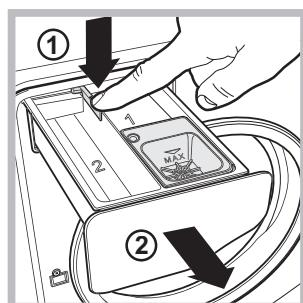
Щоб витягти касету, натисніть на важіль (1) і потягніть касету назовні (2) (див. малюнок). Промийте під проточною водою; ця процедура має проводитися регулярно.
