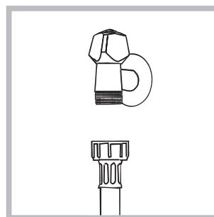
2. Підключіть трубу для подачі води, прикрутивши її до крану холодної води з різьбою ¾ (див. малюнок)
