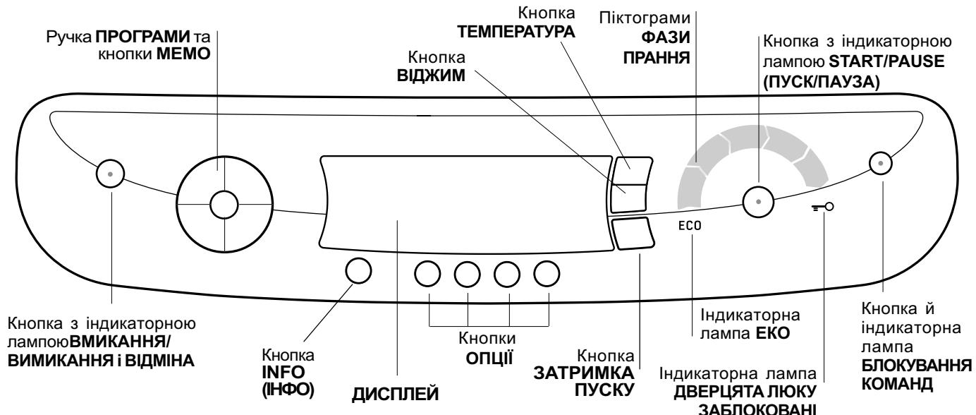
**Кнопка з індикаторною лампою ВІМІКАННЯ, ВІМИКАННЯ і ВІДМІНА:** швидко натисніть і відпустіть кнопку для вимикання або вимикання машини. Зелена індикаторна лампа означає, що машина ввімкнена. Для вимикання пральної машини під час прання необхідно утримувати кнопку натиснутою приблизно більш ніж 2 сек.; короткочасне або випадкове натискання не дозволить вимкнути машину. Вимикання машини під час циклу прання анулює дане прання.
