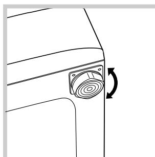
! Makinenin seviyesinin dikkatlice ayarlanması makinenin titremesini, özellikle sıkma programı çalışırken ses çıkarmasını ve yerinden oynamasını engeller.
