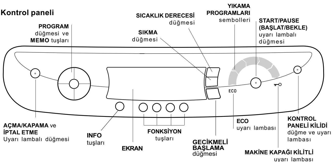
**ACMA/KAPAMA ve İPTAL ETME** ⚡ Uyarı lambalı düğmesi: makineyi açmak ya da kapatmak için bu düğmeye basınız. Yeşil uyarı lambası makinenin açık olduğunu gösterir. Makineyi çalışır vaziyetteken kapatmak için düğmeyi daha uzun, yaklaşık 2 saniye, basılı tutmanız gereklidir; hafifçe ya da yanlışlıkla basıldığında makine kapanmaz. Makinenin çalışır vaziyetteken kapatılması devrede olan yıkama programını iptal eder.
