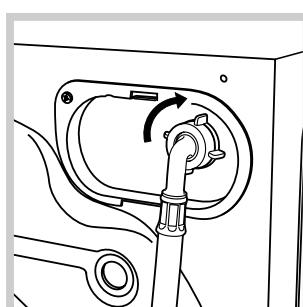
1. Su besleme hortumunu arka kısmının üst sağ köşesinde bulunan su girişine vidalayarak makineye bağlayınız (bkz. şekil).
