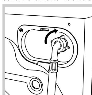
1. Підключіть шланг подачі води до машини, під'єднавши його до виходу на задньому боці угорі праворуч (див. малюнок).
