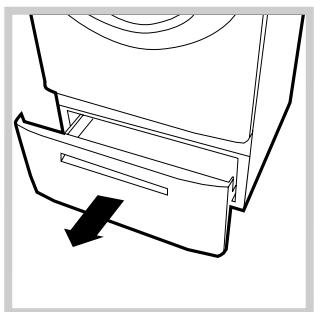
Ящик предназначается для грязного белья. Открывается, потянув его на себя (см. рисунок).
