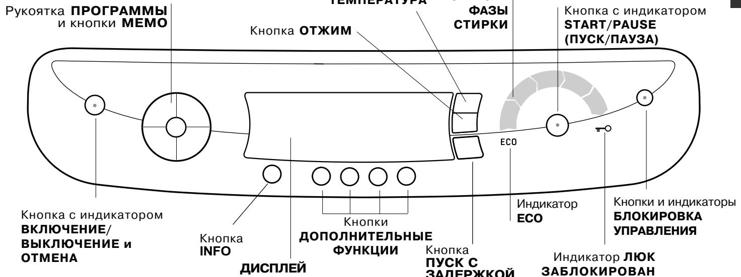
**Кнопка с индикатором ВКЛЮЧЕНИЕ ВЫКЛЮЧЕНИЕ и ОТМЕНА:** нажмите кнопку для включения или выключения машины. Зеленый индикатор показывает, что машина включена. Для отключения стиральной машины в процессе стирки необходимо держать нажатой кнопку, примерно 2 секунды. Короткое или случайное нажатие не приведет к отключению машины. В случае отключения машины в процессе стирки текущий цикл отменяется.
