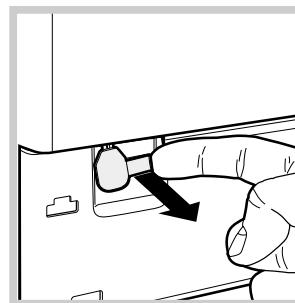
4. потяните наружу язычок, показанный на рисунке, вплоть до освобождения пластикового блокировочного винта. Затем потяните его вниз, пока не услышите щелчок, что означает разблокировку люка.
