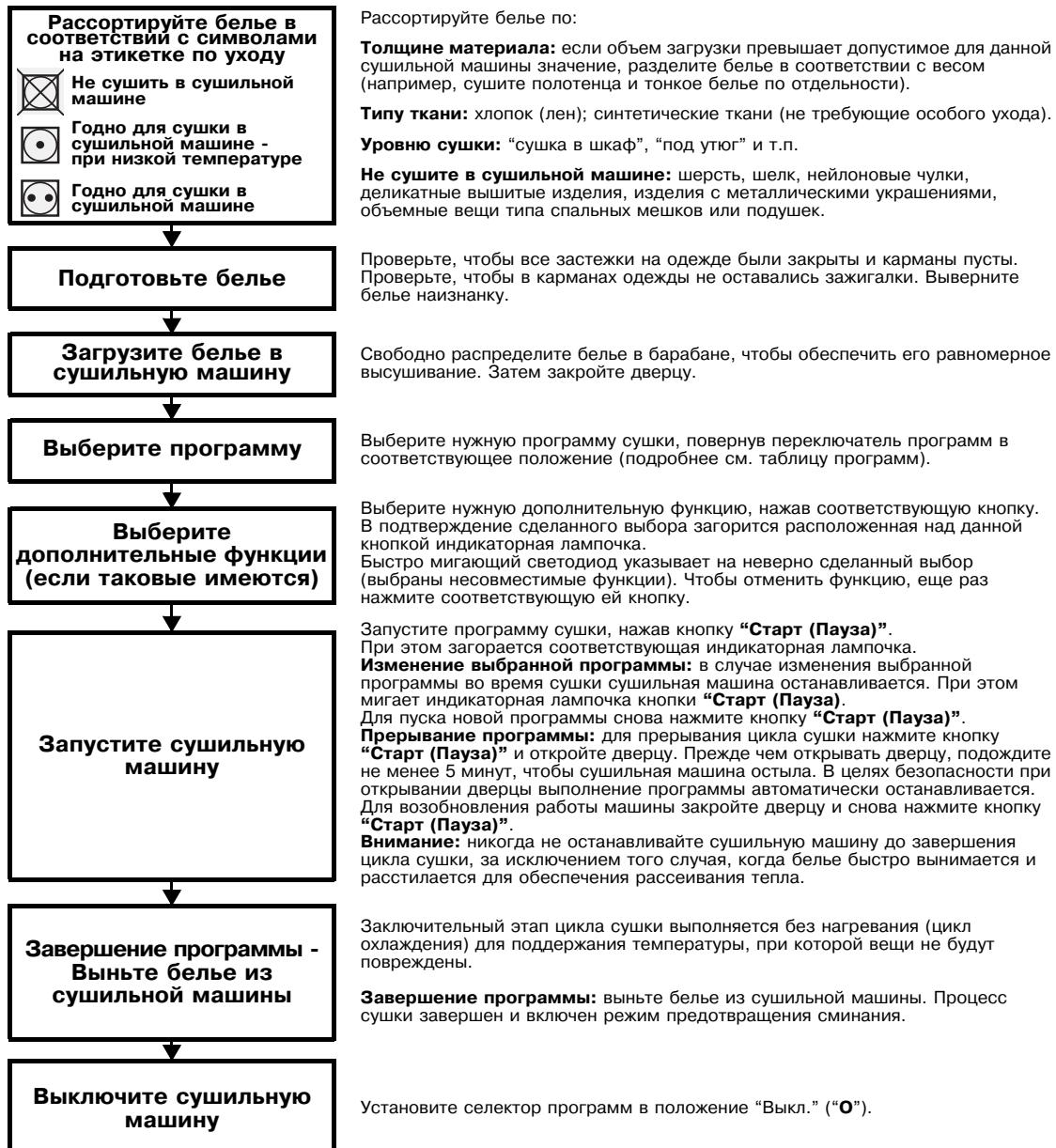
Установите селектор программ в положение **“Выкл.”** (**“0”**). **Чистка фильтра ворса (пуха):** откройте дверцу, потяните фильтр вверх, извлеките его из машины и откройте. Удалите скопившийся в фильтре пух мягкой щеткой или кончиками пальцев. Закройте фильтр и, надавив, верните его на место (более подробная информация приведена в Руководстве по эксплуатации).
