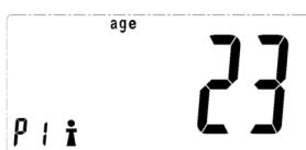
Кнопками FG установите номер пользователя (P1-P12). Затем нажмите кнопку SET, чтобы перейти к следующему параметру.
