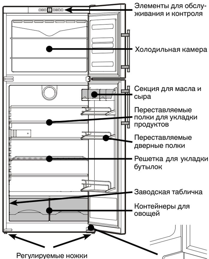
Выворачивайте регулирующую опору на опорном кронштейне до тех пор, пока она не будет опираться на пол, затем крутите далее по углом 90°.
