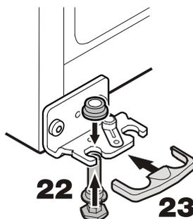
При необходимости выровняйте двери в двух продольных отверстиях внизу и по центру опорного кронштейна вровень с корпусом прибора.
