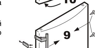
10. Переставьте пружинный зажим на противоположную сторону.
