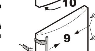
9. Переставьте ручки и пробки на противоположную сторону.
