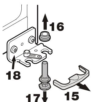
19. Переставьте опору шарнирного уголка на противоположную сторону.
