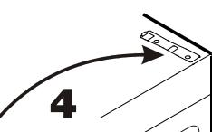
4. Переставьте защитную крышку на противоположную сторону.
