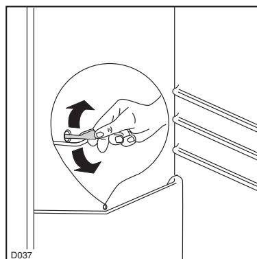
Морозильная камера, однако, постепенно будет покрываться наледью. Ее следует удалять специальным прилагаемым к холодильнику пластиковым скребком при условии, что толщина наледи не превышает 4 мм. При выполнении этой операции не требуется выключать электропитание или удалять из холодильника продукты.
