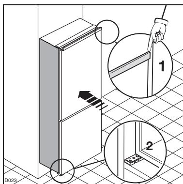
Прикрепите прибор с помощью 4 винтов, входящих в комплект, прилагаемый к холодильнику.
