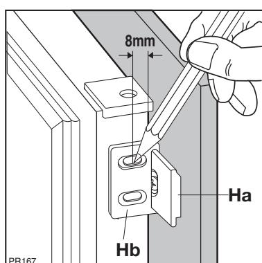
Снимите кронштейны и отметьте расстояние 8 мм от внешнего края дверцы для гвоздя (K).
