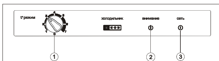
1- ручка терморегулятора; 2 - индикатор (красного цвета) «Внимание»; 3 - индикатор (зеленого цвета) «Сеть».
