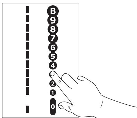
Прикоснитесь к отметке нужной ступени нагрева на линейке управления. Загорятся индикаторы ступени нагрева.
