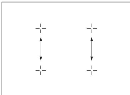
Система управления мощностью делит мощность между двумя конфорками, составляющими пару (см. иллюстрацию). Функция повышения мощности повышает мощность до максимального уровня для одной конфорки в паре и автоматически снижает мощность на второй конфорке. Информация на индикаторе конфорки, мощность на которой снижена, чередуется.
