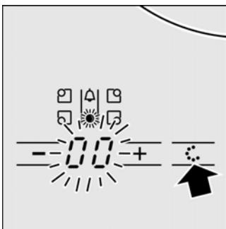
На бытовом таймере Вы можете устанавливать время до 99 минут. Он работает независимо от всех остальных установок.
