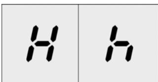
Для каждой конфорки на варочной панели предусмотрен индикатор остаточного тепла. Этот индикатор показывает, какая конфорка еще горячая. Индикатор остаточного тепла показывает две ступени нагрева.
