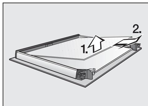
■ **Слегка** приподнимите внутреннюю панель дверцы и выньте ее из пластмассовых планок.
