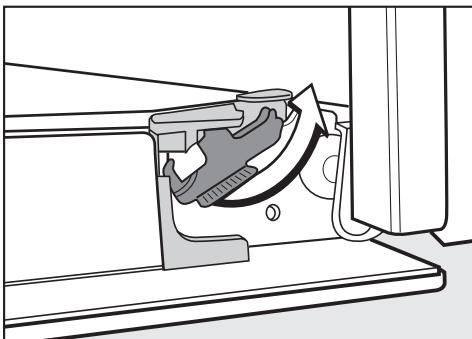
■ Разблокируйте скобы на обоих шарнирах вращательным движением. При этом переведите скобы до упора в установку под углом.
