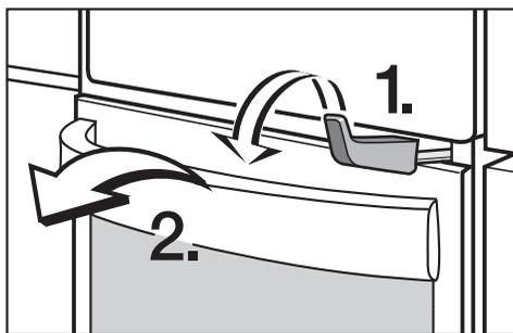
Система блокировки укреплена под панелью управления и блокирует открывание дверцы. С помощью монтажной лопатки дверца может быть открыта.
